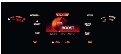
Цветной многофункциональный дисплей системы изменения настроек динамики «Nissan Dynamic Control System», отображающий настройки автомобиля
